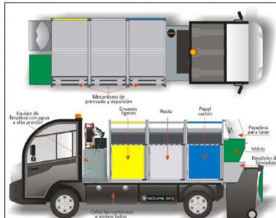
Vehículo con equipo de limpieza con agua a presión y compartimentos para recogida de papeleras
