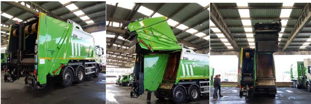
Este camión bicompartimentado es de Ros Roca, y dispone como se puede ver de dos cajas totalmente independientes. La distribución en cuanto a cubicaje de las cajas se realiza en función de las necesidades del cliente y del tipo de residuo a recoger, y el tamaño del mismo se define en base a estas mismas consideraciones pudiéndose adquirir vehículos de ente 8 y 16 m3 de capacidad. Simplificando la idea, es como si se dispusiera de “dos camiones en uno”.
